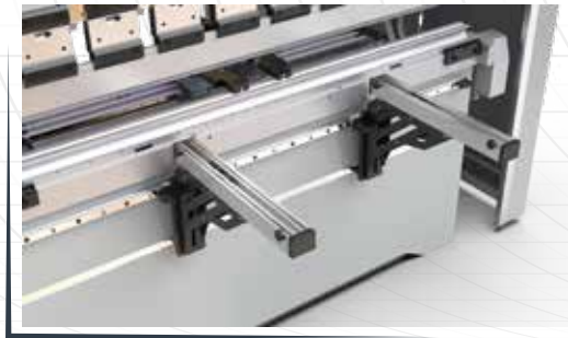
Lineer Kızaklı, Alüminyum Gönyeli Ön Sac Destek Sistemi
