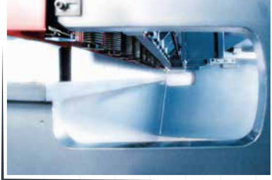
■ Boğaz Derinliği Minimum 350 mm olan boğaz derinliği bıçak boyundan daha uzun sacların kesilmesine olanak sağlar.
