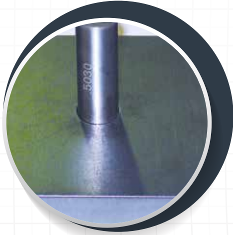
■ XPR Plazma İle True Hole Teknoloji İle Kesimi
